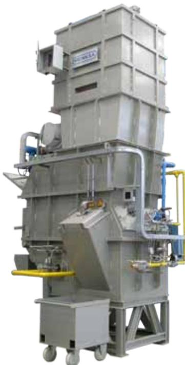
La cámara de mantenimiento está situada bajo la cámara de fusión.
