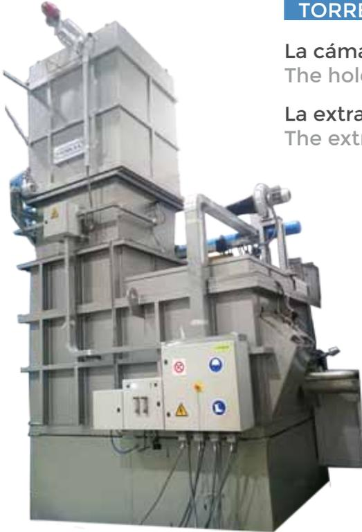
La cámara de mantenimiento está alineada con la cámara de fusión.
